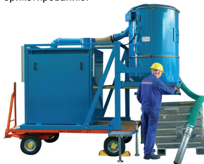
S-1700 E Закреплен на платформенной тележке. Клапан выгрузки увеличенного диаметра DN 800 мм, для несylучих и прессующихся материалов, склонных к брикетированию.
