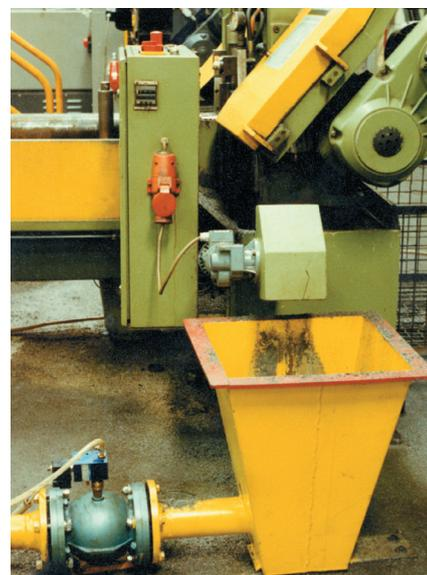
В процессе фрезерования образуется смесь металлической стружки и СОЖ, которая накапливается в сборной воронке. Через подсоединенный к сборной воронке вакуумный трубопровод осуществляется периодическая откачка смеси.
