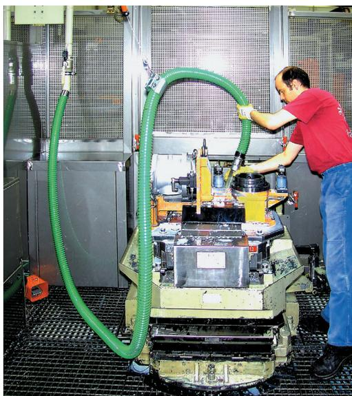
Очистка производственного оборудования металлообрабатывающей промышленности. Централизованный сбор смазочно-охлаждающей жидкости (СОЖ) и металлической стружки с последующим отделением и возвратом в производственный процесс СОЖ.
