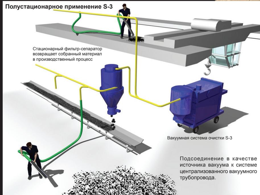
Стационарный фильтр-сепаратор возвращает собранный материал в производственный процесс
