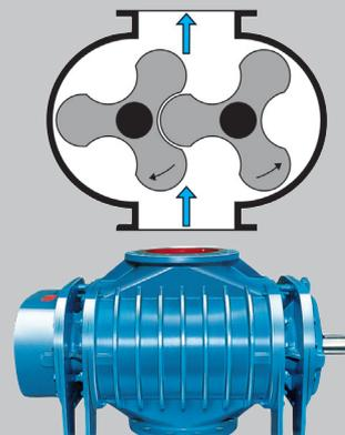
Агрегаты S-3 оснащаются вакуумными насосами нового поколения с высоконадежной 2-х роторной системой генерации вакуума.
