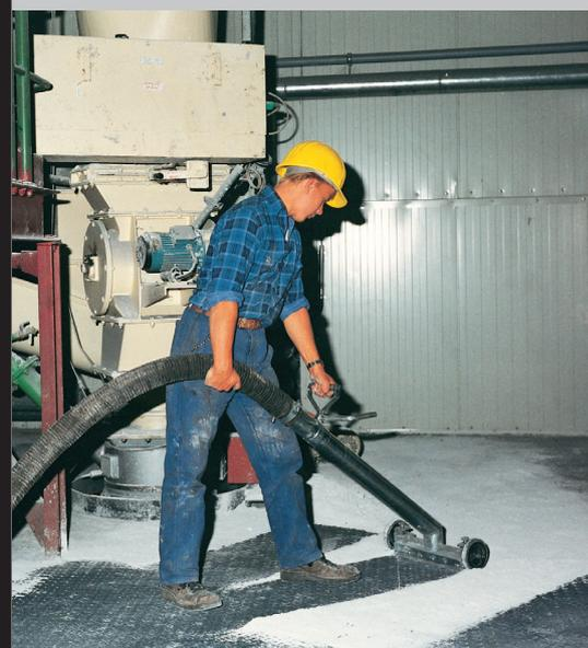
Сборный бункер 120, 160 и 500 л. Стационарное или передвижное исполнение (шасси для тяжелого груза). S-3 способен удовлетворить самые высокие требования к производительности и фильтрующей способности при сборе и вакуумной транспортировке большого количества сыпучего материала.
