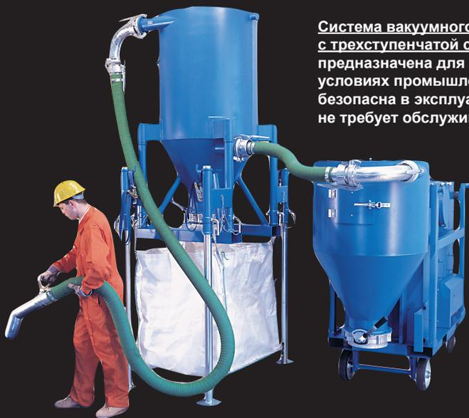
**Система вакуумного сбора и очистки S-3 с трехступенчатой системой фильтрации** предназначена для работы в тяжелых условиях промышленных производств, безопасна в эксплуатации и практически не требует обслуживания.
