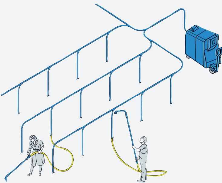
MaxVac T позволяет убирать территорию на расстоянии до 100 м от пылесоса. Сердце агрегата - мощный вихревой вакуумный насос - не требует обслуживания.
