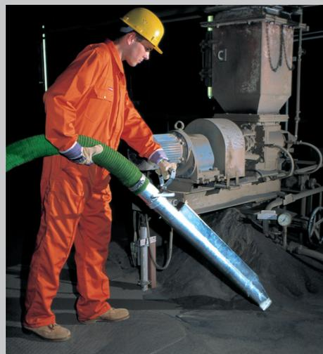
Оптимальная скорость транспортировки материала и обеспечение устойчивой мощности всасывания за счет применения насадок с системой подмеса воздуха.
